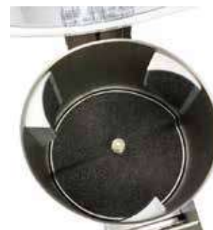
Revolvedores laterales y plato abrasivo.
